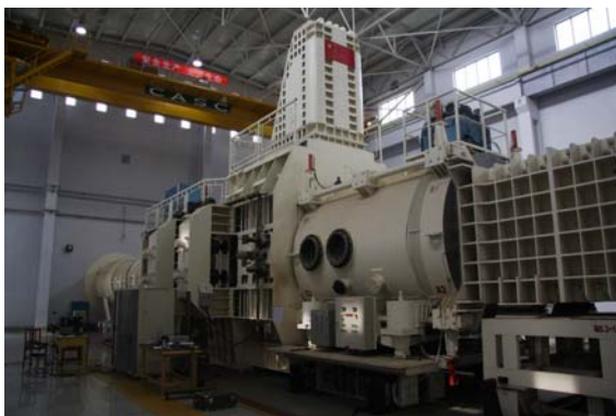
图 1 在航天部三院 FD-06 跨音速风洞进行减阻试验
