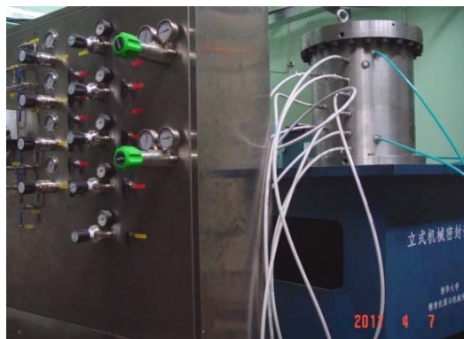
主氦风机干气密封试验装置
