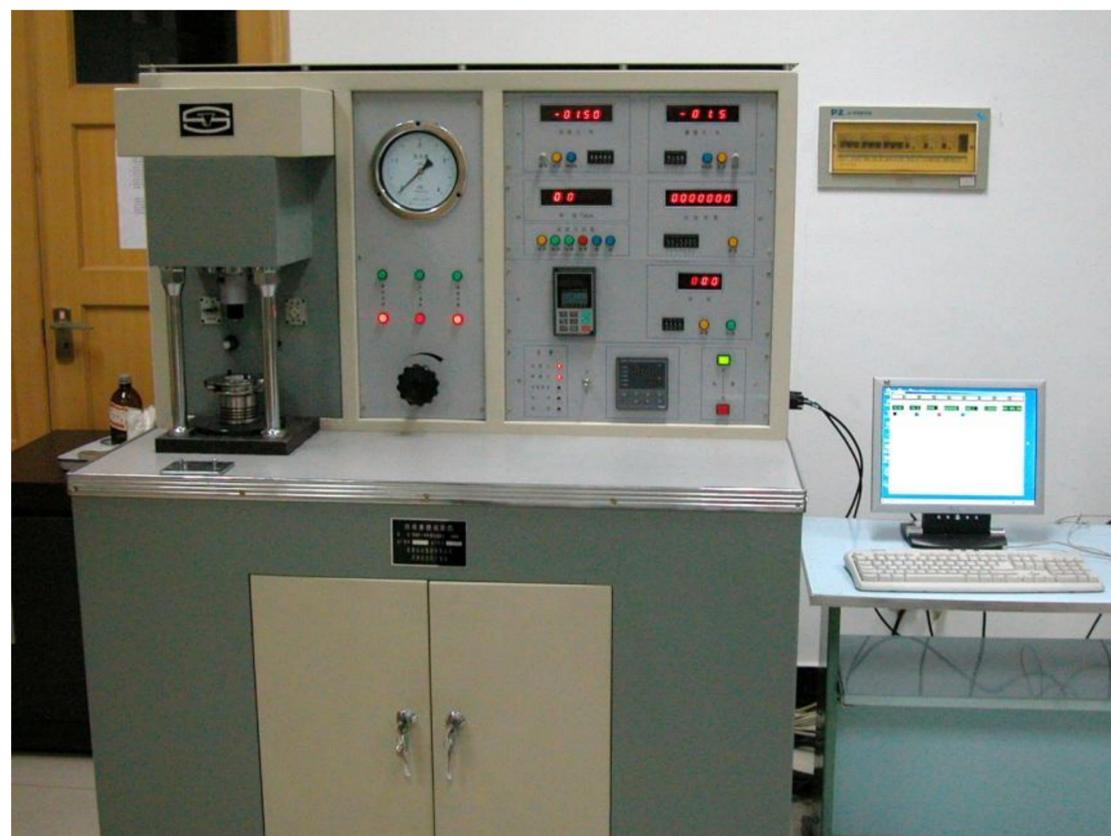
该试验机采用滑动摩擦形式，在极高的点接触压力条件下，评定润滑剂的承载能力，包括最大无卡咬负荷PB，烧结负荷PD，综合磨损值ZMZ等三项指标：
